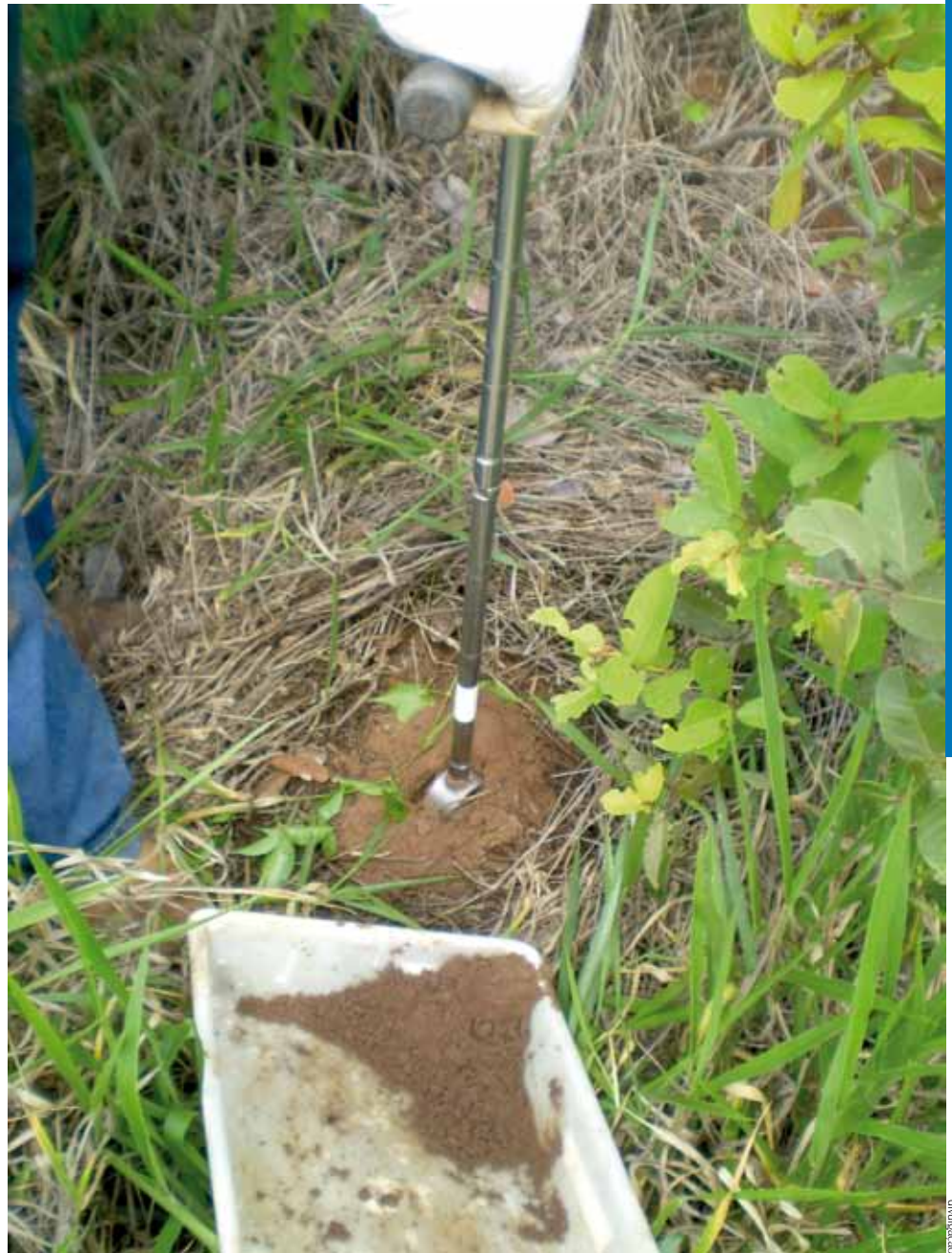
Vista da retirada de amostra de solo, série testemunha, do campo de apodrecimento de Luis Antônio (SP).
