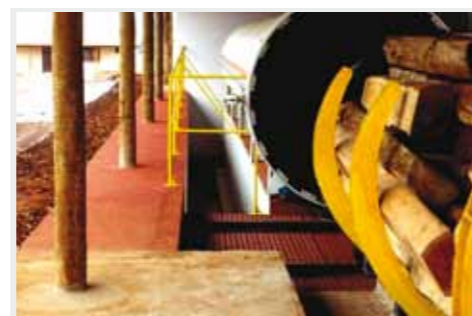
Tratamento de madeira em autoclave
